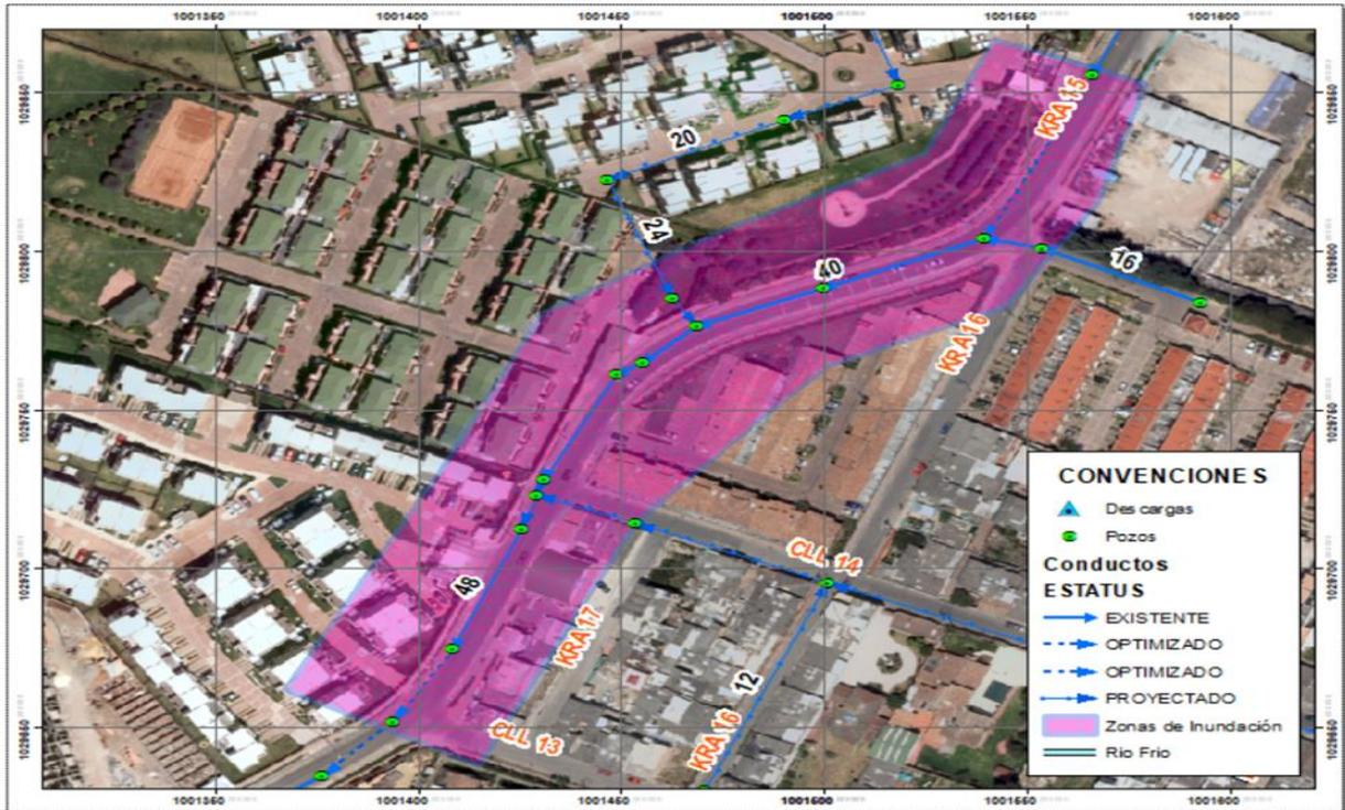
**Calle 12 –Frente Office Chía:** Implementación de colectores pluviales de 12" a 27" a conectar con la red pluvial instalada por la constructora Amarillo SAS (Mediano Plazo). De manera puntual se deberá tener en cuenta los diseños comprendidos entre las Calle 11 y Calle 12 y las Carreras 1D y 1 D.
