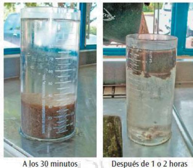
Ilustración 113. Prueba de Sedimentación con efecto de elevación de lodos tomada de Consorcio ambiental Cogua
