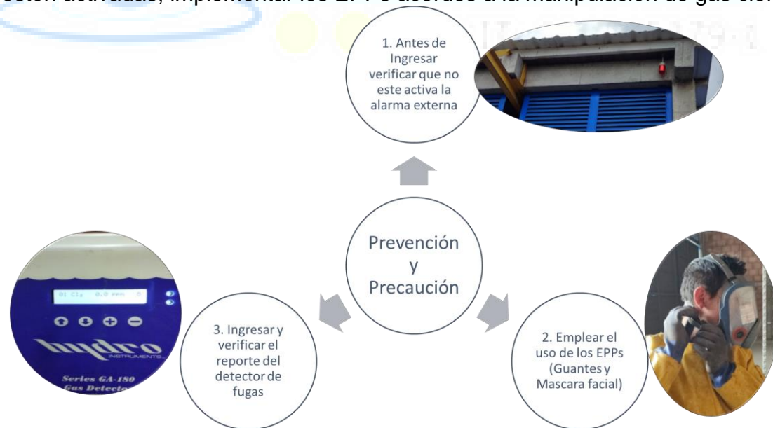
Ilustración 83. Recomendaciones de Seguridad en la caseta de cloración
