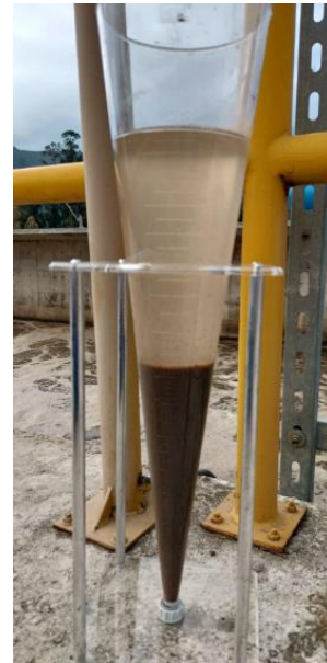
Ilustración 73. Cono de Sedimentación de Imhoff de un Reactor estabilizado después de 30min
