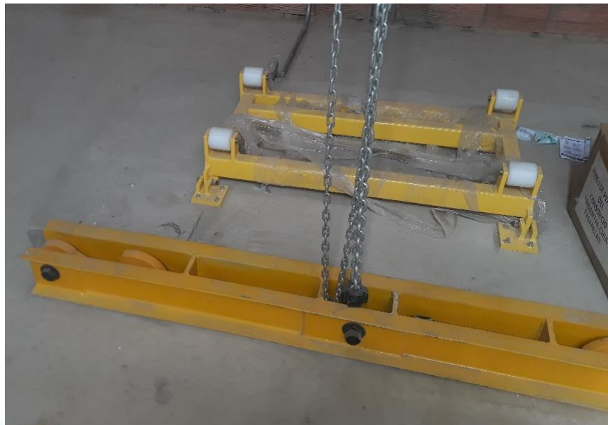
Ilustración 44. Fotografía Sistema Bascula y viga de izaje de Cilindro de Gas Cloro
