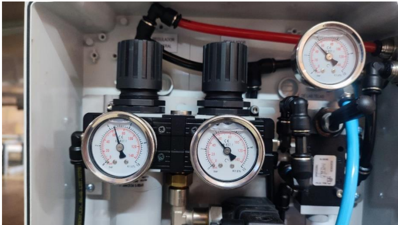
Ilustración 44. Manómetros Presión de Bandas del Equipo EMO
